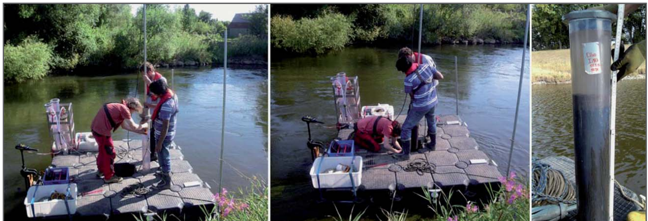
Obr. B-A2-8-4: Odběr jader sedimentů za účelem zjištění erozní stability v hloubkovém profilu a ke zjištění doplňkových ukazatelů, jako je zrnitostní složení a hutnost uložených sedimentů v hloubkovém profilu (zdroj: IWS 2013a)
