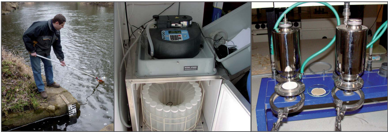
Obr. B-A2-2-1a: Metody odběrů a analýz vzorků: ruční odběr vzorku, automatický vzorkovač ISCO, tlaková filtrace (zleva) – zdroj: J. Haliřová, ČHMÚ
