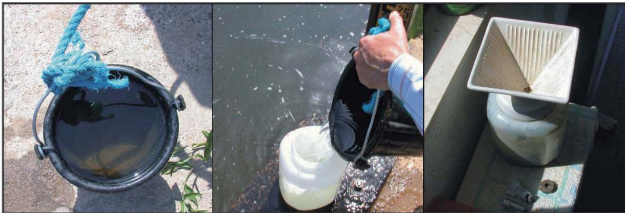
Obr. B-A2-2-1b: Metoda odběru vzorků – vědro na odběr vzorků (5 l), plnění vzorku do plastové nádoby (mimořádné vzorky) a normovaná keramická nálevka pro filtraci v místě odběru (zleva) – zdroj: I. Quick, BfG
